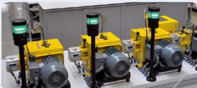
Технологические процессы и сырьё оказывают чрезвычайное влияние на свойства и рабочие характеристики пластичной смазки. Практически невозможно выбирать или сравнивать пластичные смазки, руководствуясь только их составом. Для получения значимых данных требуются эксплуатационные испытания. За более чем 100 лет работы компания SKF накопила огромные знания о взаимодействии смазочных материалов и деталей механизмов.
